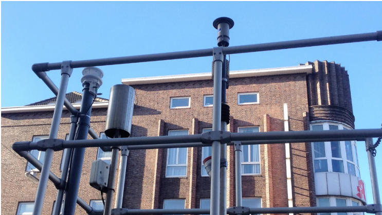
Abbildung 1: Aufbau einer Luft-Messstation in Bremen zur Messung und Überwachung der NO 2 -Konzentration und anderen Spurengasen. Foto: Eike Gutt
